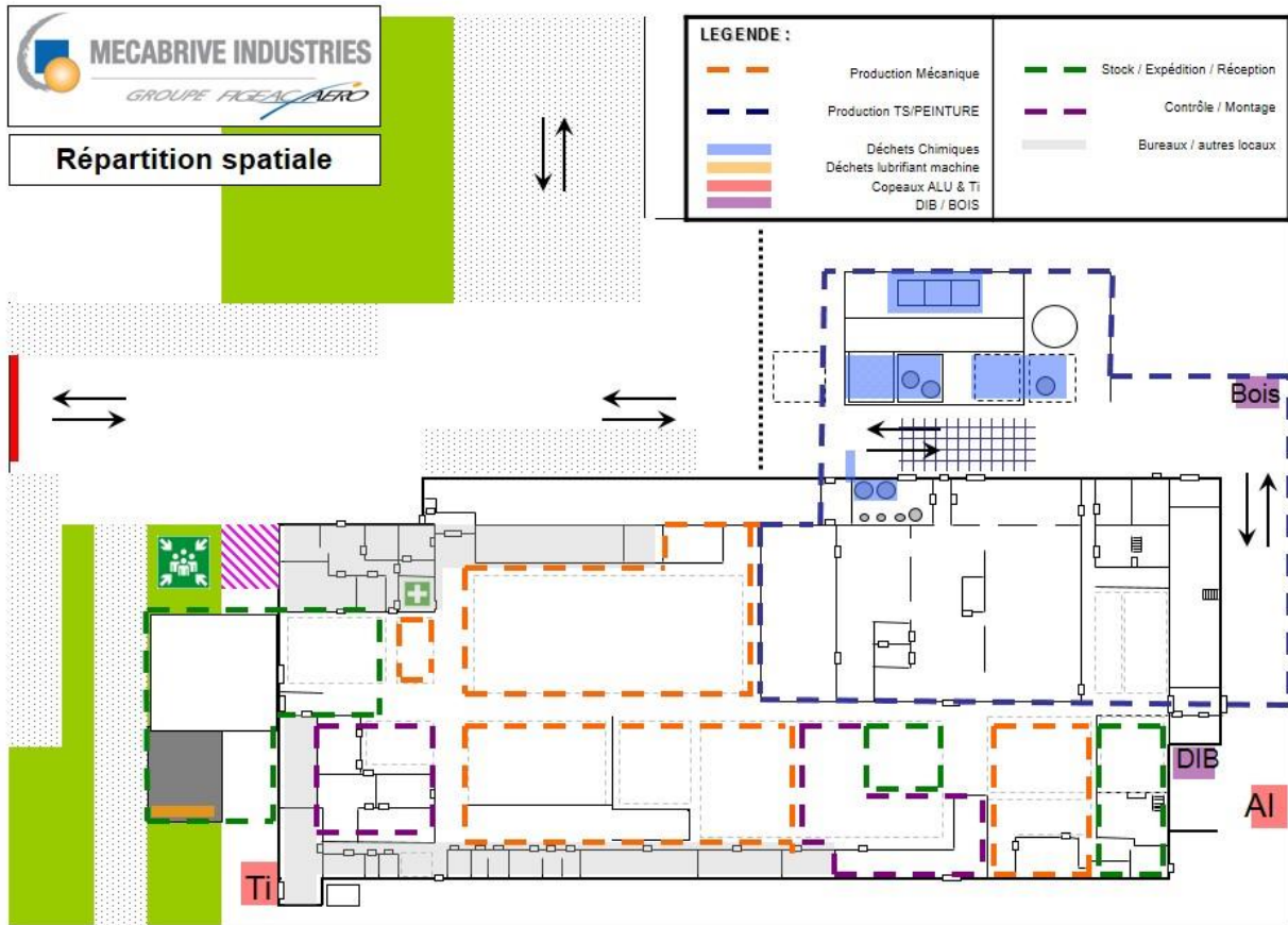
Figure 27 : zones de stockage des déchets
