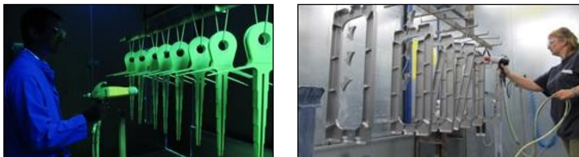
Figure 14 : ressuage, application du pénétrant
