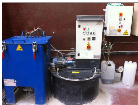
Figure 25 : recyclage des effluents de tribofinition par centrifugation
