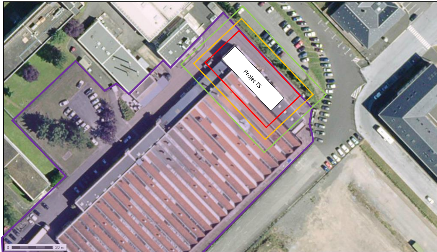
Figure 63 : modélisation incendie atelier de TS projeté
